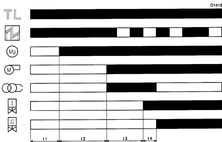
**t1** – время предварительной циркуляции топлива
