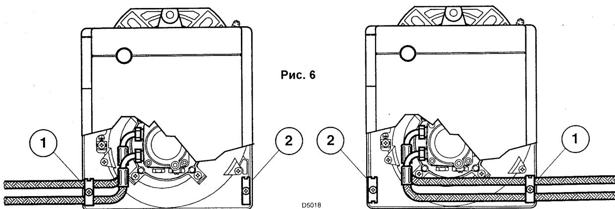
На обеих сторонах корпуса горелки предусмотрены гнезда для топливных шлангов.
