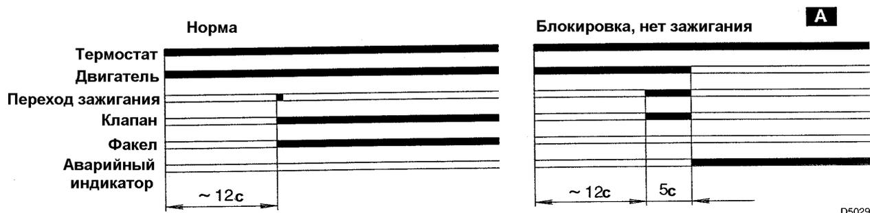
**A** - обозначается загоранием аварийного индикатора на пульте управления (3, см. рис. 1 на стр. 1).
