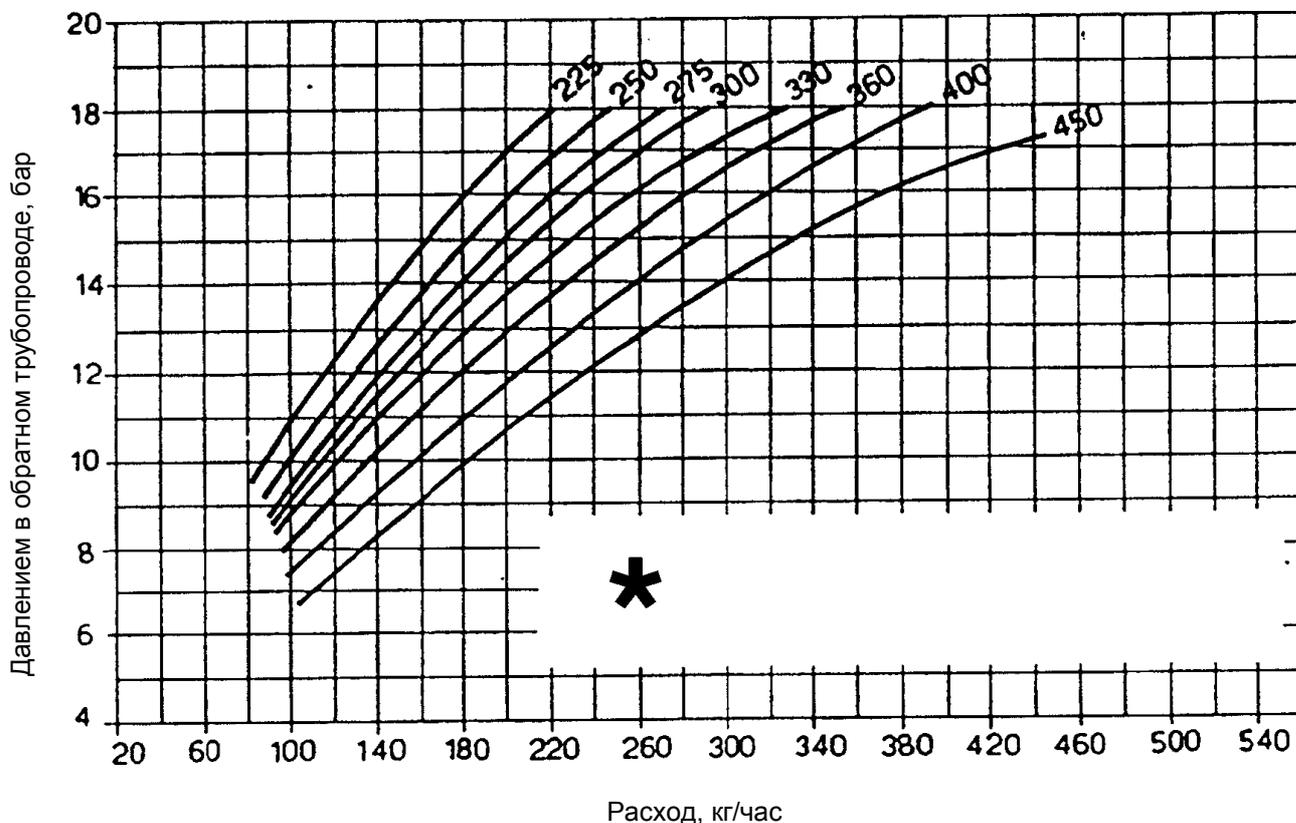
(\*) диаграмма составлена для форсунок производства фирмы Fluidics, типа N1 - 50° для давления в прямом трубопроводе 25 бар.
