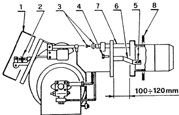
**ОТВЕРСТИЯ ВО ФЛАНЦЕ КОТЛА И НАСКОЛЬКО ДОЛЖНА ВЫСТУПАТЬ ГОЛОВКА ГОРЕЛКИ**
