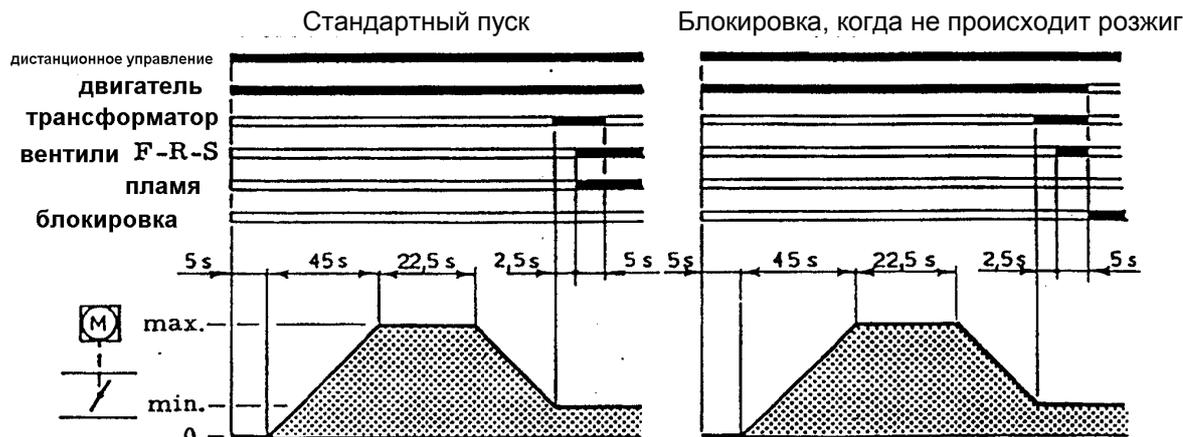
**БЛОКИРОВКА ДВИГАТЕЛЯ:** реле тепловой защиты двигателя останавливает работу в случае перегрузки или при отсутствии одной из фаз.
